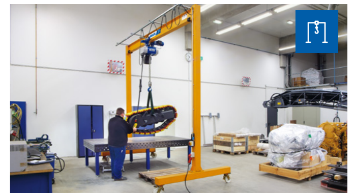
Przestawne wciągarki bramowe LPK
